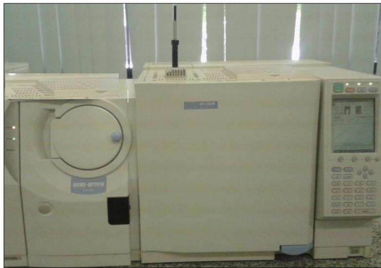
**Figura 10.** Cromatógrafo a gás acoplado ao espectrômetro de massa (MS) para identificação e quantificação de compostos voláteis com a fibra de SPME no injetor.
