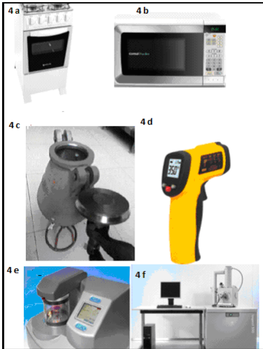
Figura 4. Equipamentos utilizados para o processamento e análise das amostras; 4a. Fogão a gás; 4b. Forno de microondas; 4c. Canhão de expansão; 4d. Termômetro digital; 4e. Metalizadora; 4f. Microscópio eletrônico de varredura.
