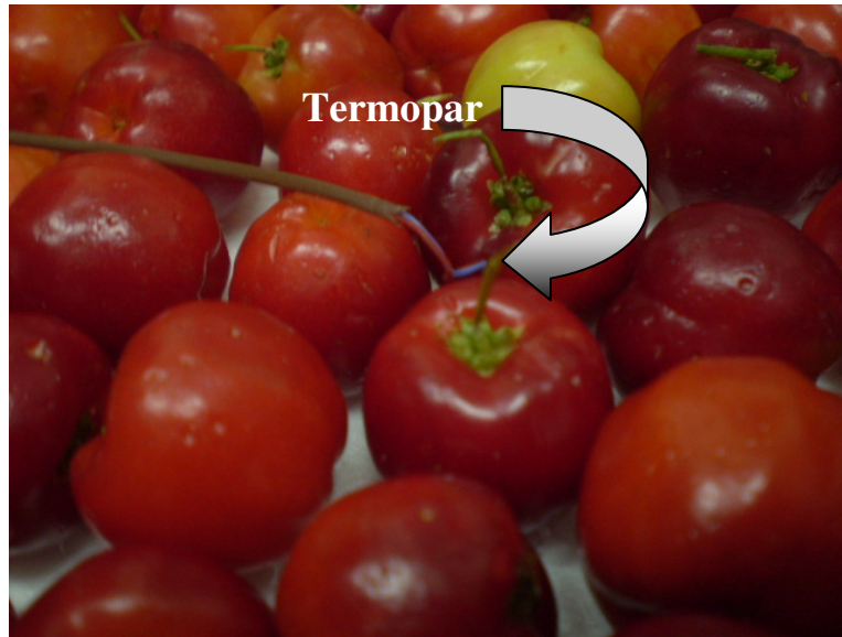
Figura 7 – Termopar inserido no fruto.
