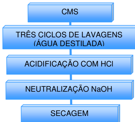
FIGURA 5 - Fluxograma de obtenção de Concentrado Protéico de Peixe CPP em escala de laboratório – Método 1
