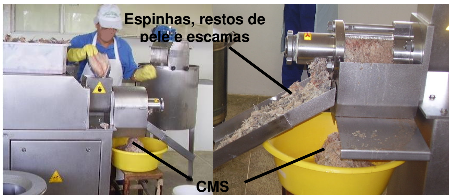
FIGURA 4 – Recuperação da carne utilizando-se máquina despoldadora de pescado, marca High Tech, modelo HT 250.
