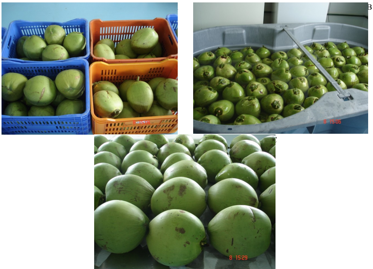
Figura 2 - Chegada dos frutos à planta piloto de processamento (2A), detalhe da sanitização dos frutos sendo imersos em solução de hipoclorito de sódio (2B) e secagem dos frutos a temperatura ambiente (2C).
