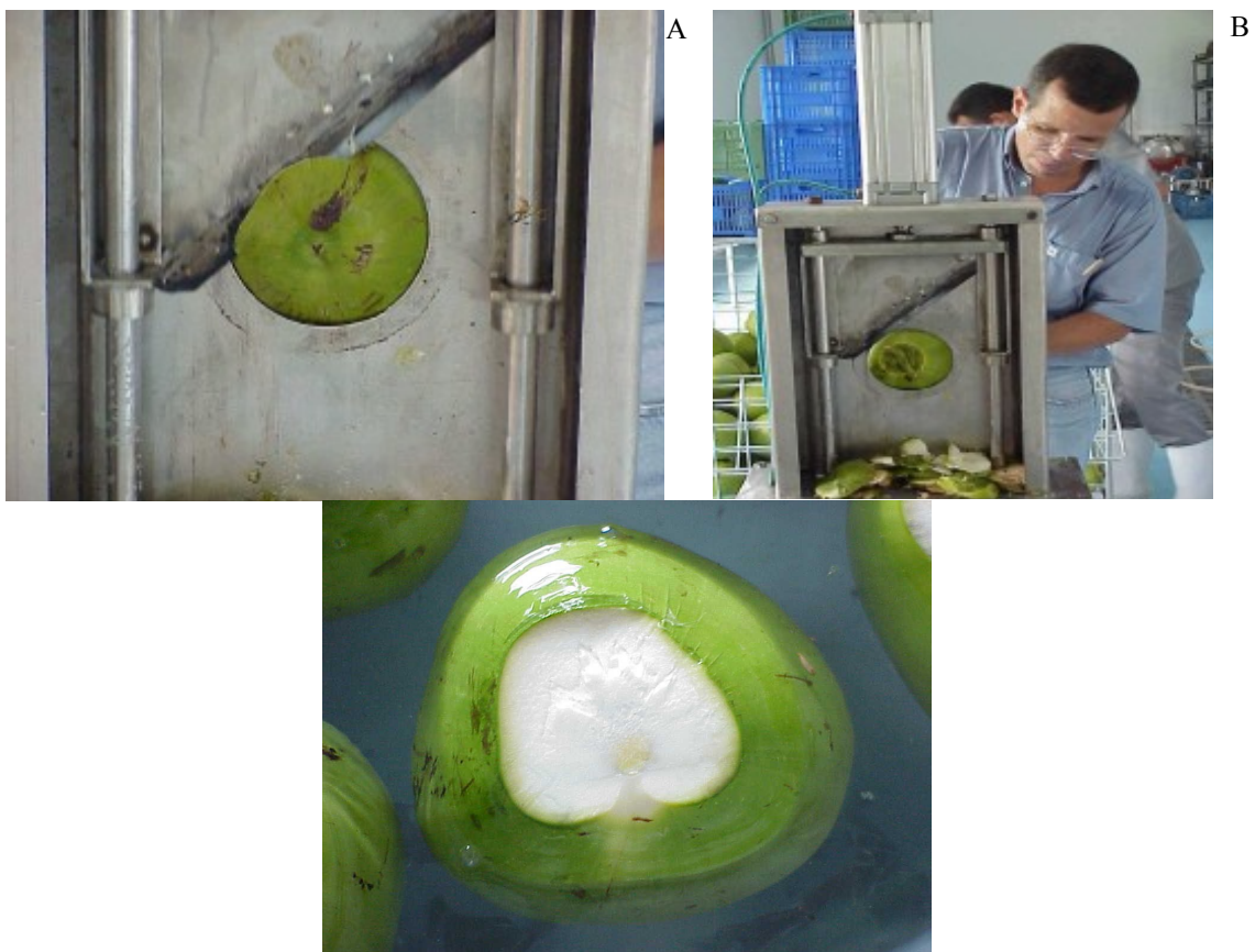
Figura 3 - Detalhe das operações de corte durante o processamento mínimo de frutos de coqueiro da variedade Anã Verde (3A e 3B), seguido de tratamento em solução antioxidante (3C) através de imersão, durante 10 minutos.
