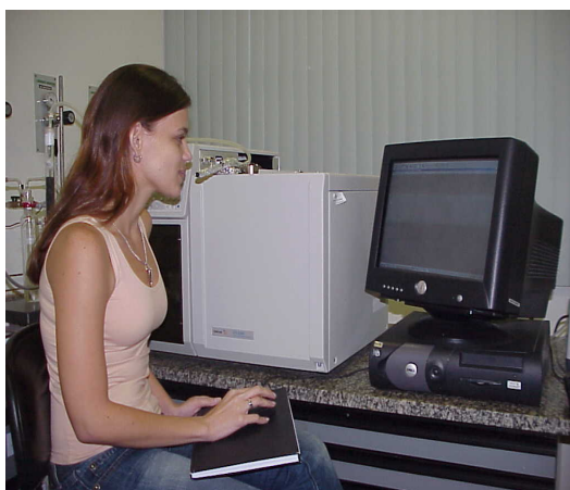
Figura 11 - Análise olfatométrica através da técnica Osme . Detalhes do julgador utilizando o mouse do computador para registrar a intensidade do odor percebido (A) e detalhe da analista anotando a descrição do odor (B).
