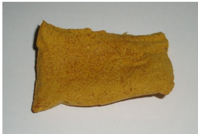
Figura 4 – Aspecto “emborrachado” apresentada pelo ensaio controle com 60 dias de armazenamento.
