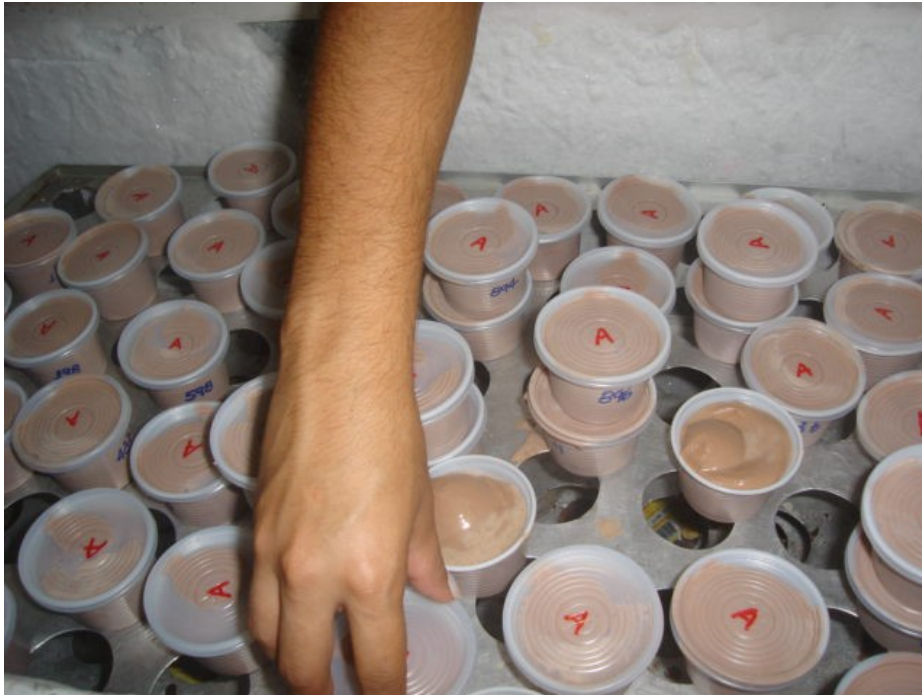
Figura 9: Colocação manual das tampas para congelamento final em câmara de congelamento a - 25°C
