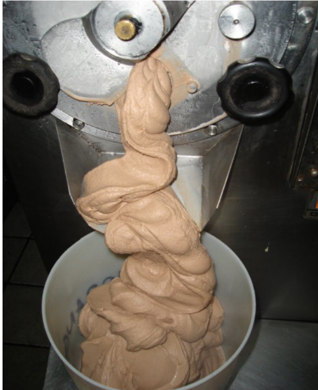
Figura 7: Saída do Sorvete da Produtora: congelamento parcial
