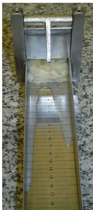
Figura 24. Polpa de bacuri tratada enzimaticamente com separação de fases (amostras com, aproximadamente, 3 e 12 U/mL de PG), decorridos 30 segundos após a abertura da armadilha.
