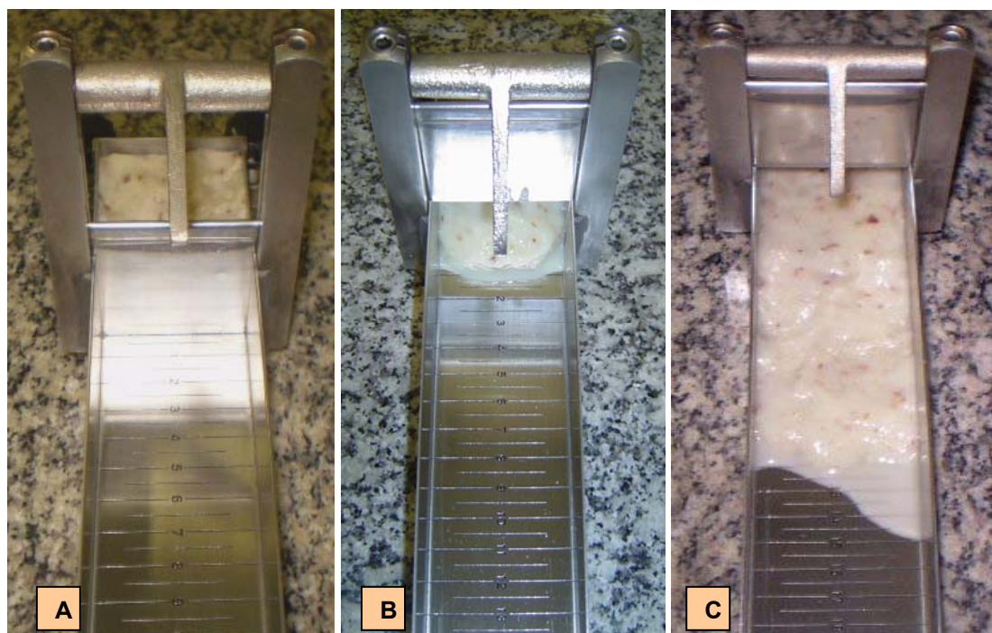
Figura 23. Polpa de bacuri antes da abertura da armadilha (A), fluxo observado para polpas sem adição de preparação enzimática (B) e para polpas após o processo de maceração (C).
