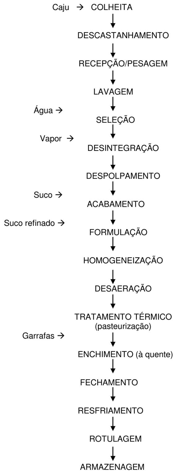
Figura 1 - Fluxograma das operações seguidas para obtenção do suco tropical de caju envasado pelo processo *hot fill*.
