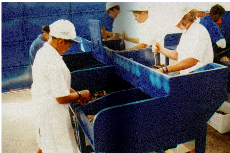
Figura 10 - Corte da castanha de caju utilizando máquina manual.
